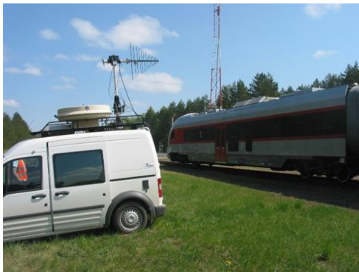
23 Pav. RRT specializuotas automobilis, pastatytas prie traukinio bėgių, matuoja važiuojančio traukinio elektromagnetinių trikdžių spinduliuotę.
