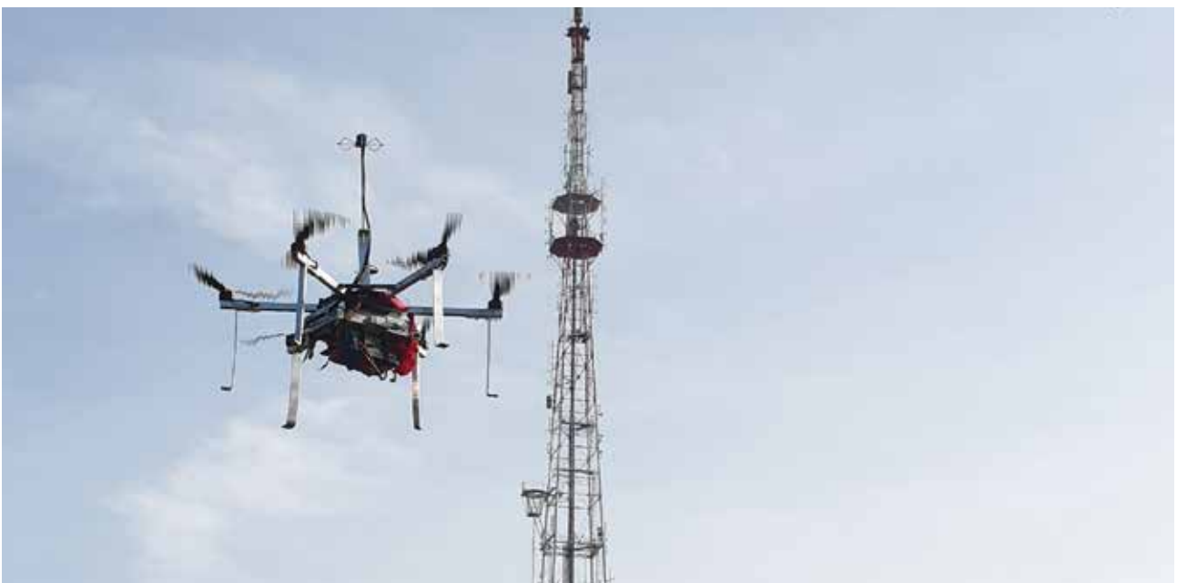
Bepilotis orlaivis prie Girulių bokšto. Matuojama antenos spinduliavimo diagrama.
